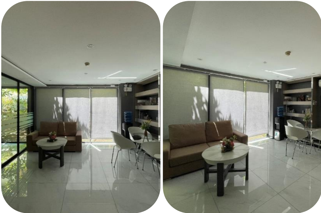
ภาพที่ 2-3.1.2(2) ลดความร้อนโดยติดม่านกรองแสงแดด
